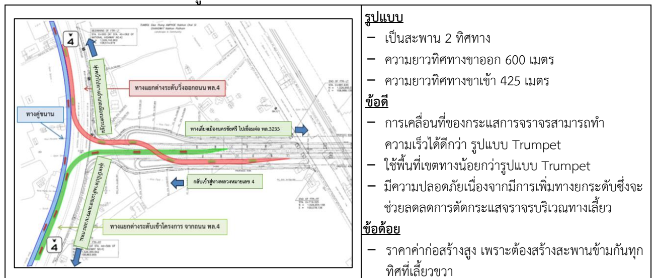
รูปที่ 8 รูปแบบที่ 4 Y Type (Y Interchange หรือ Directional Ramp) บริเวณชิดขอบทางเท้า
