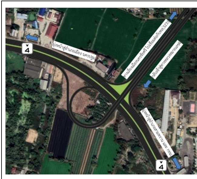
รูปที่ 5 รูปแบบทางแยกต่างระดับ รูปแบบที่ 1 Trumpet Type (T Interchange)
