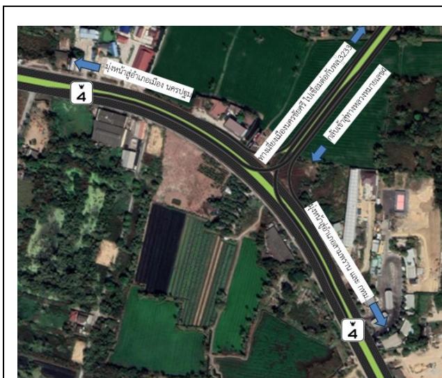
รูปที่ 6 รูปแบบทางแยกต่างระดับ รูปแบบที่ 2 Y Type (Y Interchange หรือ Directional Ramp)
